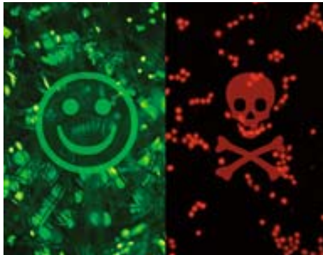
Lebende Zellen auf einem unkritischen Material (grün) können durch negativen Einfluss (ungeeignete Sterilisation, nicht ausreichende Reinigung, falsches Material) abgetötet werden (rot).
