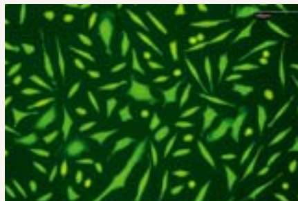
Was die Prüfer sehen: Ist ein Werkstoff im Labortest nicht toxisch, erscheinen die Zellen in dieser Vitalfärbung grün
